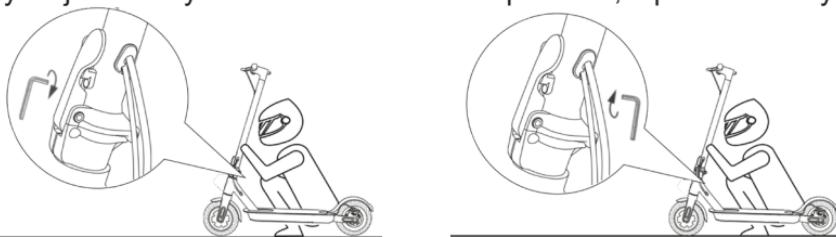
Pokud se při jízdě přední tyč elektrické koloběžky třese, utáhněte dva šrouby na sklopném mechanismu šestihranným klíčem M5. Pokiaľ sa pri jazde predná tyč elektrické kolobežky trase, utiahnete dve skrutky na sklopnom mechanizme šesťhranným klíčom M5.
