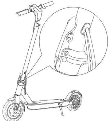
Rozložte tyč řídítek a zatlačte na ni, dokud neuslyšíte cvaknutí.
