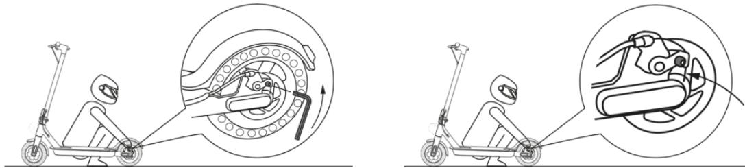
Pokud máte pocit, že brzdy příliš přiléhají, povolte šrouby přítlačné desky na kotoučové brzdě pomocí šestihranného klíče M5, mírně uvolněte lanko brzdy tak, abyste zkrátili jeho odkrytou koncovou část a poté utáhněte šrouby přítlačné desky. Máte-li pocit, že jsou brzdy volné, nebrzdí, povolte šrouby přítlačné desky, vytáhněte kabel brzdy tak, aby se jeho odkrytá koncová část mírně prodloužila, a poté šrouby utáhněte.
